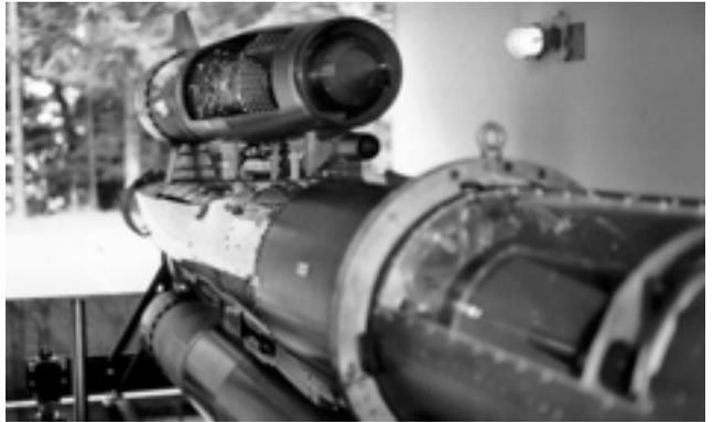
**Oben: Das Schnittmodell durch das Staustrahltriebwerk der Lenkwaffe.**
